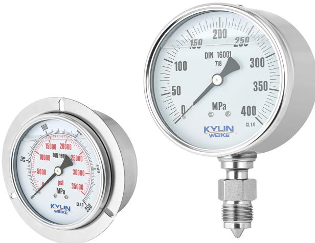
P600系列专为高压应用设计, 耐受压力最高达600MPa。按照DIN16001高压标准的要求制造。该安全型压力表由夹层安全玻璃、测量系统和固体挡板以及防爆背板组成。发生故障时, 位于仪表前方的操作员会受到保护, 因为介质或仪表零件只能从仪表的背面喷射出去。
