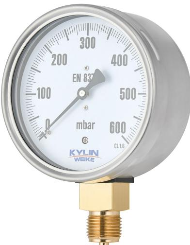
P160 膜盒压力表适用于极低压力的测量。在加压时, 膜盒元件会发生膨胀, 其膨胀程度与所受压力成正比, 并将该压力传递至指针运动机构从而实现压力指示。
